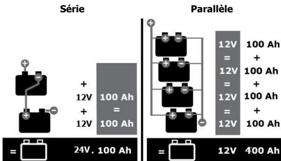
NB : La résistance des câbles dans chaque chaîne doit être la même (même section, même longueur).
