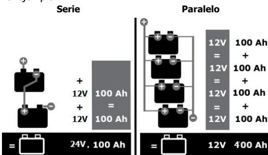
NB: La resistencia de los cables dentro de cada cadena debe ser la misma (misma sección y misma longitud).
