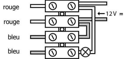
Nb : la tension du luminaire doit être identique au détecteur de mouvement.
