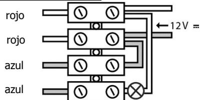
Nota: la tensión de la luminaria debe ser idéntica a la del detector de movimiento.
