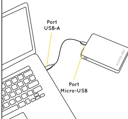
Vous pouvez également charger votre Gravity avec votre ordinateur portable en connectant un câble micro-USB au port USB-A de l'ordinateur et au port micro-USB de la Gravity.
