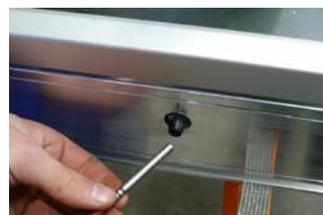
Câble de la sonde – Rallongement avec 2 x 0,75 mm<sup>2</sup> à 50 m de longueur de câble, sinon 1,5 mm<sup>2</sup>.
