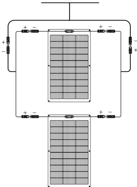
**Il est recommandé de connecter des modules avec la même sortie électrique dans la même série pour éviter que des erreurs de correspondance ne créent un effet 1+1<2.**
