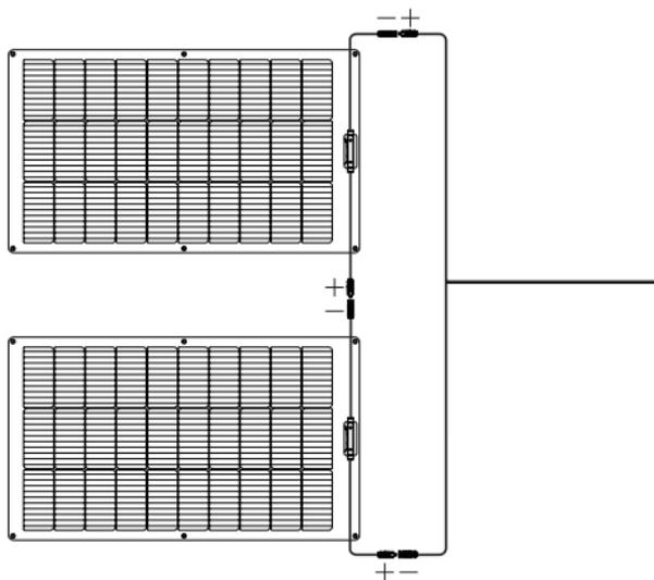
La connexion parallèle est illustrée sur le schéma suivant :
