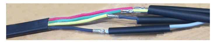
2/ Protéger les connexions avec les gaines thermo-rétractables à l'aide d'un décapeur thermique.
