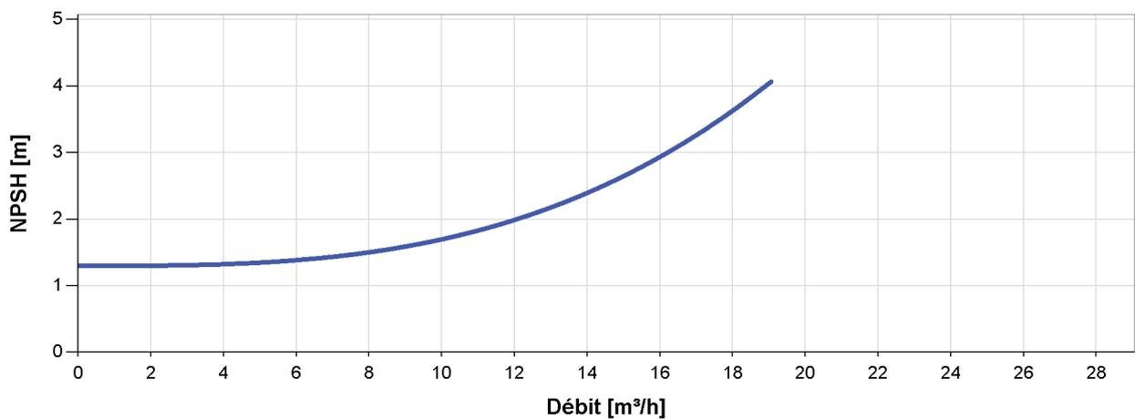
Le NPSH (Net Positive Suction Head) n'est pas la hauteur d'aspiration opérationnelle. Pour calculer la hauteur d'aspiration opérationnelle, s'il vous plaît voyez le manuel d'utilisation.
