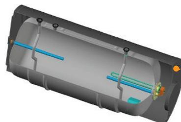
Le ballon est composé de deux enveloppes émaillées permettant d'accueillir le liquide caloporteur (eau glycolée) en partie «externe» et l'eau potable dans le compartiment central.
